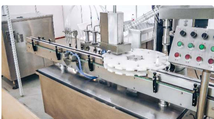
Automatisk utrustning för tappning och täckning av flaskor i läkemedelsproduktion Farmaceutisk tablettpress · 26.11.2020 · 79.140K utsikt
