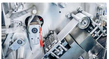
İlaç üretiminde blisterlerde otomatik tablet ve kapsül paketleme ekipmanları
