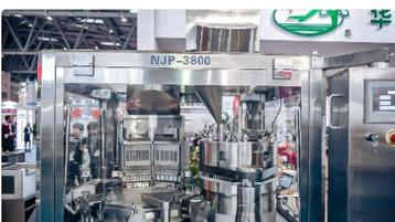
Sert jelatin kapsüller için otomatik kapsül ekipmanı
