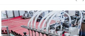
Plastik ilaç şişeleri için otomatik doldurma ve kapatma makinesi
